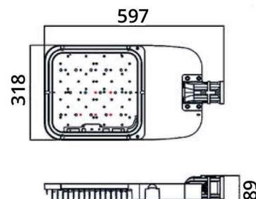
A Luminária Pública utiliza tecnologia MULTILED, o que possibilita um ótimo dimensionamento de seus dissipadores de calor. Essa tecnologia é montada em placa de circuito impresso com ensaios elétricos, fotométricos e laudos IES realizados em laboratórios homologados pelo INMETRO.
